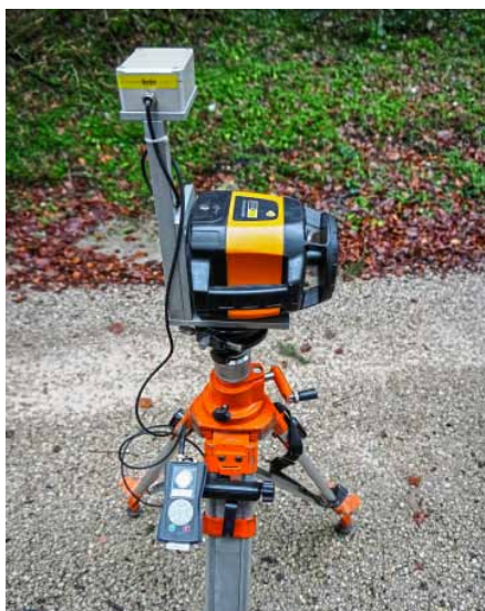
Abb. 3: Das Richtlasersystem wird an dem vormarkierten Punkt platziert. Der Maschinenführer folgt dem Laserstrahl und legt dabei die Rückegasse an.
